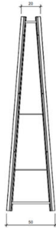
greencityWALL Schnitt Gerüst M 1:10
